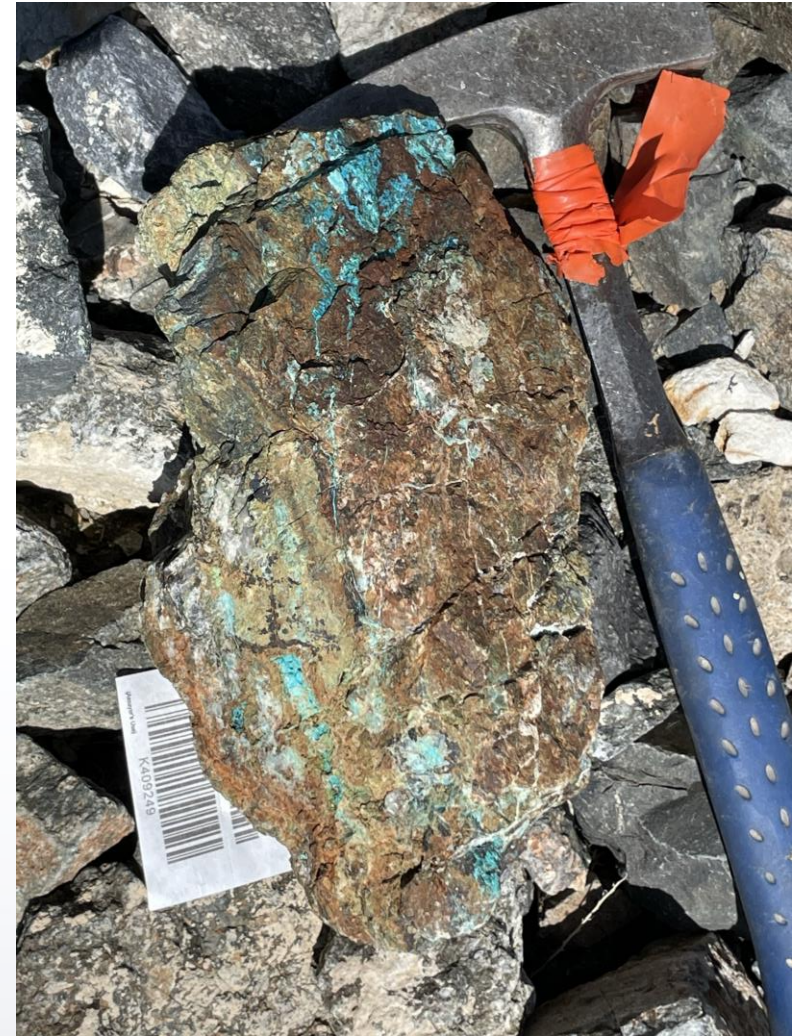
Mineralized boulder: 2.5% Cu, 2.4 g/t Au
